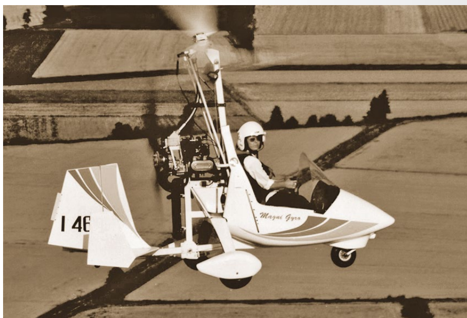
• Vírník M18 Spartan vybavený motorem Rotax 582
